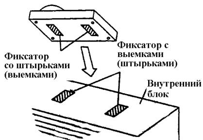
Во избежание падения адаптера не используйте фиксаторы Veicro для крепления корпуса на стене или иной вертикальной поверхности.
