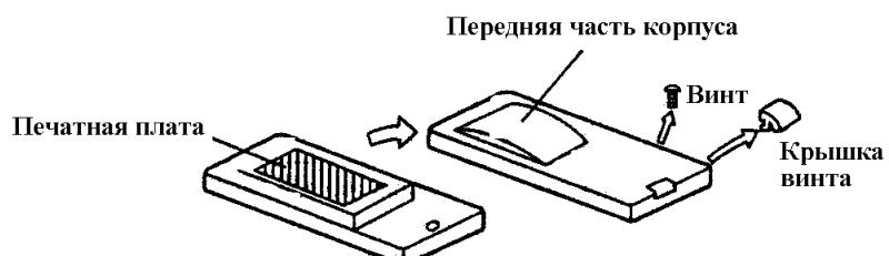
Снимите крышку, закрывающую винт, вывинтите один из винтов и снимите переднюю часть корпуса адаптера.
